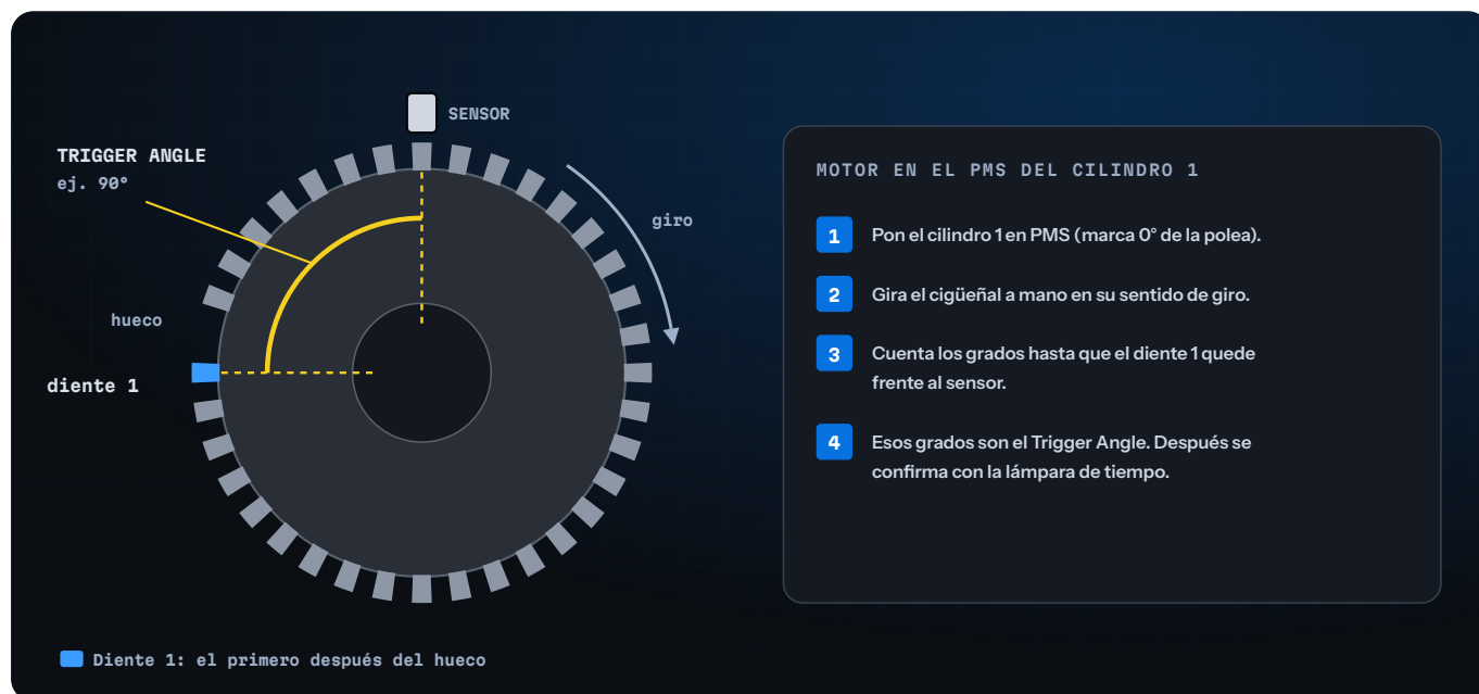
Figura 9.2 Rueda 36-1 vista con el motor en el PMS del cilindro 1. El Trigger Angle son los grados de cigüeñal desde el PMS hasta que el diente 1 (el primero después del hueco) pasa frente al sensor. El valor de 90° es solo un ejemplo: cada motor tiene el suyo.
