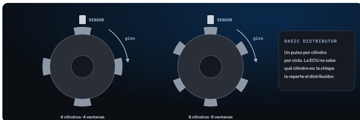
Figura 9.7 Rueda de distribuidor (Basic Distributor): un pulso por cilindro, sin dientes faltantes. Funciona, pero con poca resolución; si puedes, cambia a una rueda de dientes faltantes en el cigüeñal.
