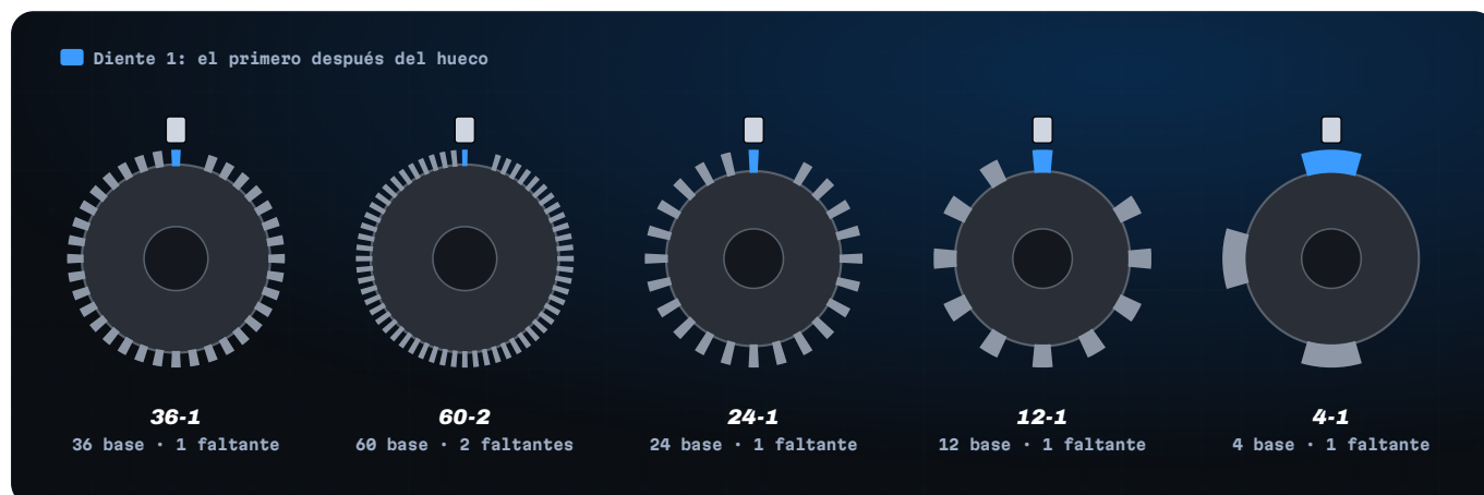
Figura 9.3 Ruedas de dientes faltantes más comunes, todas con el diente 1 frente al sensor. En TunerStudio se escribe el número de dientes como si no faltara ninguno (36, 60, 24...) y, aparte, cuántos faltan.
