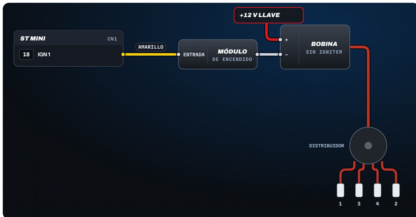
Figura 6.6 Encendido con distribuidor (Single Channel): una sola salida de la ECU maneja un módulo de encendido externo, que carga la bobina; el distribuidor reparte la chispa a cada bujía en el orden de encendido. El módulo lleva además su +12 V con llave y su tierra, según su propio diagrama.
