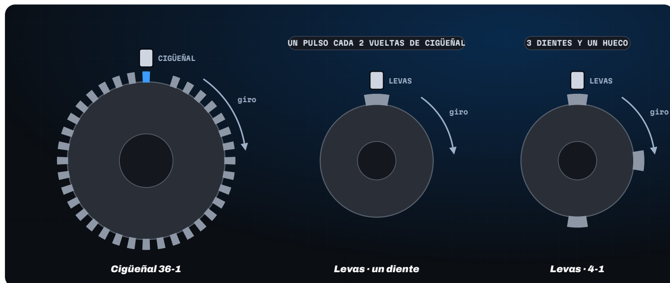
Figura 9.4 Para inyección o encendido secuencial (ST-04 y ST-100) la ECU necesita, además del cigüeñal, una señal del árbol de levas que diga en qué vuelta del ciclo está el motor: un solo diente (o media luna) por vuelta del árbol de levas, o una rueda 4-1.
