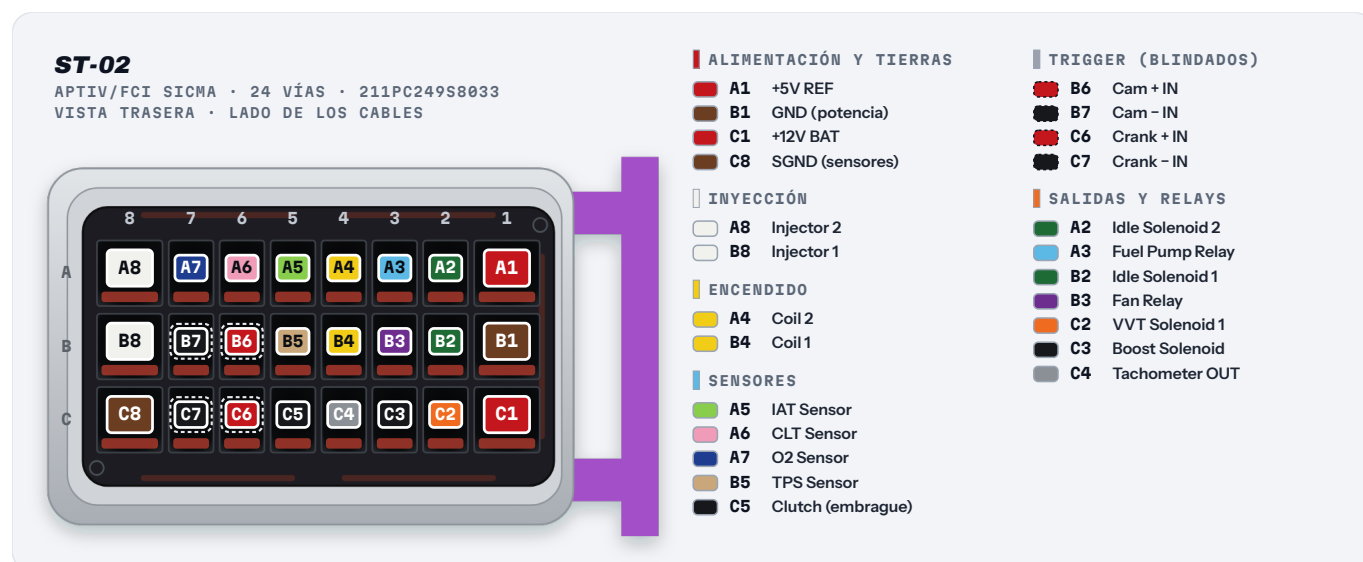
Figura 2.2 Conector de la ST-02 (Aptiv/FCI Sicma de 24 vías) visto por detrás: traba morada a la derecha, fila A arriba y columna 1 del lado de la traba. Las columnas 1 y 8 son para terminales más grandes.
