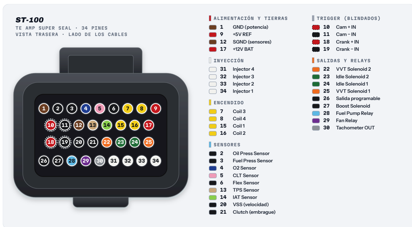
Figura 2.4 Conector de la ST-100 (TE AMP Superseal de 34 vías) visto por detrás. Los pares blindados son 10-11 (levas) y 18-19 (cigüeñal).
